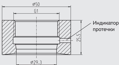
Для удовлетворения требованиям ЗА установка сварной опоры должно выполняться так, чтобы отверстие дренажа утечки всегда располагалось в самой нижней точке. Шероховатость поверхности сварного шва должна составлять  $Ra \leq 0,8$  мкм.
