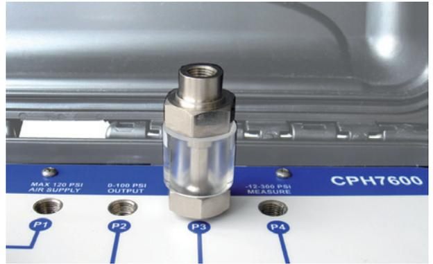
**Wally Box III, modelo CPH7600 con filtro atrapador de contaminantes montado**
