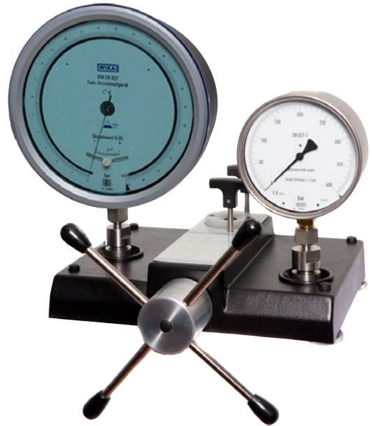
Ensemble d'étalonnage CPP1200-X avec manomètre de test comme étalon et comparateur
