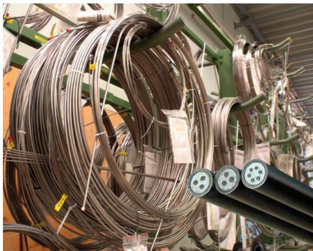
Cavo con isolamento minerale (cavo MI)
