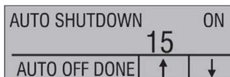
Die Option "AUTO OFF DONE" wählen, um die Parameter zu übernehmen und ins Hauptdisplay zurückzukehren. Die automatische Abschaltzeit wird zurückgesetzt, sobald eine Taste gedrückt wird.
