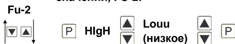
Чтобы выполнить индикацию при снижении ниже минимального предельного значения, можно выбрать Low (LOW = минимальное предельное значение), а если значение возрастает и превышает верхнее предельное значение, можно выбрать high (HIGH = верхнее предельное значение). LOW соответствует принципу тока покоя, а HIGH - принципу рабочего тока.
