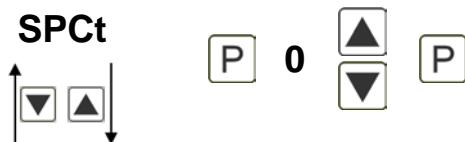
В дополнении к начальному и конечному значению, 8 дополнительных точек срабатывания могут быть определены для линеаризации нелинейных значений сенсора. Отображаются только параметры активированной точки срабатывания.
