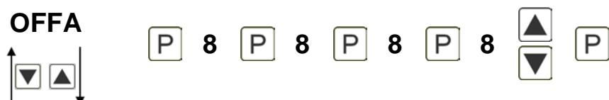
С помощью данной функции Вы можете изменить масштаб значения входа 4-20 mA ( заводская настройка) без применения измерительного сигнала. Если выбрана калибровка сенсора, данные параметры не доступны.
