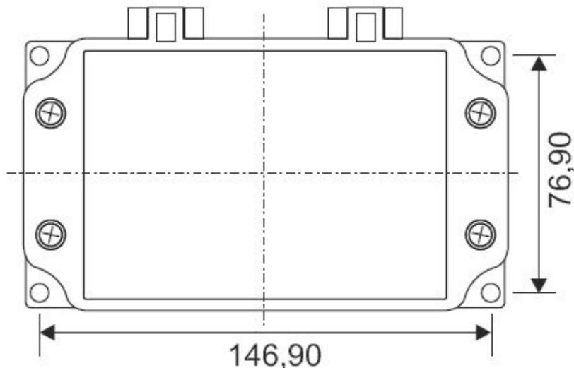
Закрепите корпус для монтажа на стене с помощью соответствующего материала (винтов) в четырех монтажных отверстиях.
