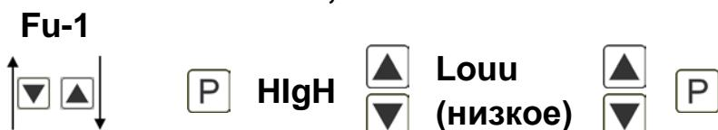
Чтобы выполнить индикацию при снижении значения ниже минимального предельного значения, можно выбрать **Low** (**LOW** = минимальное предельное значение), а если значение возрастает и превышает верхнее предельное значение, можно выбрать **HigH** (**HigH** = верхнее предельное значение). **LOW** соответствует принципу тока покоя, а **HigH** - принципу рабочего тока.
