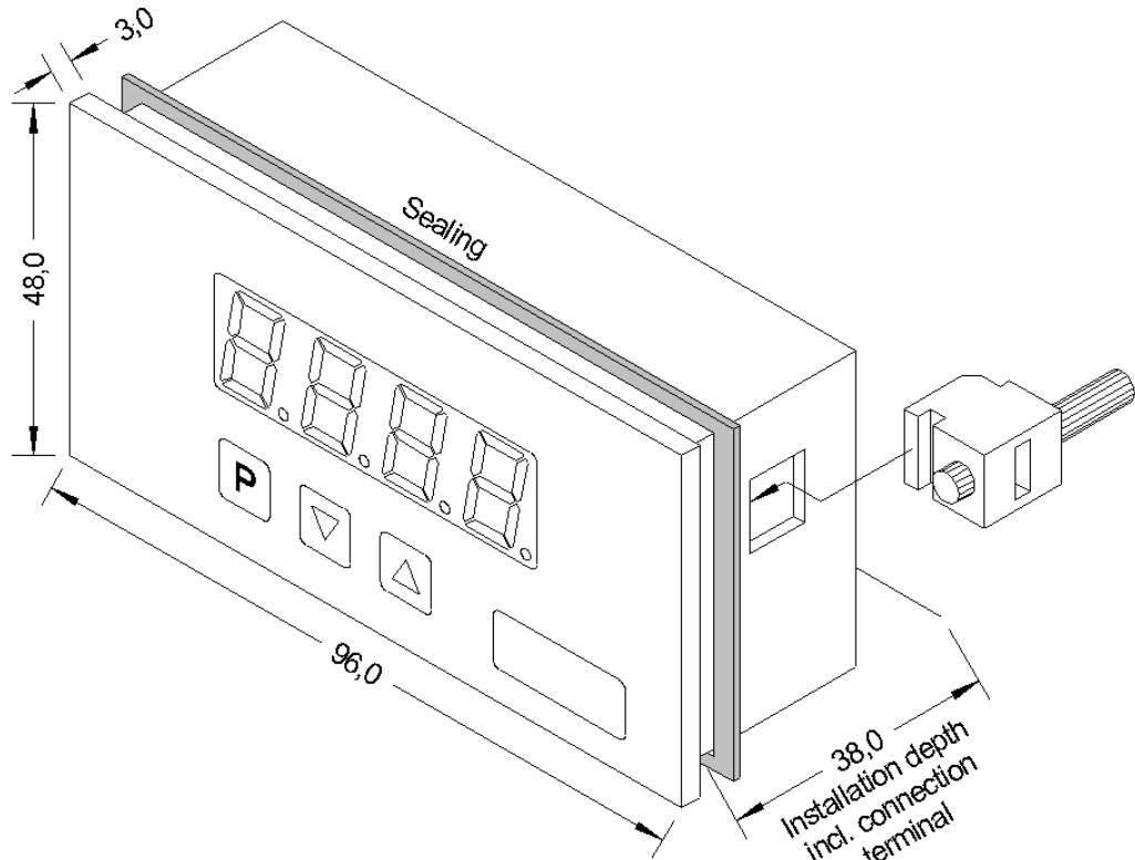
1. После удаления фиксирующих элементов, вставьте прибор.
