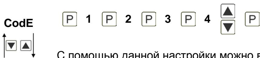
С помощью данной настройки можно выбрать индивидуальный код (рабочая настройка 1 2 3 4) для блокировки клавиатуры. Для блокировки/активирования кнопки действуйте согласно разделу меню run.
