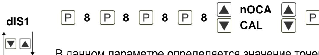
В данном параметре определяется значение точек срабатывания. После завершения калибровки сенсора, а также достижении предельного значения/смещения выводится запрос о необходимости выполнения калибровки.
