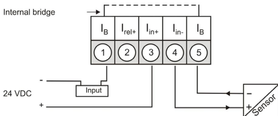
**c) Прибор токовой петли в сочетании с 3-пров. сенсором:**
