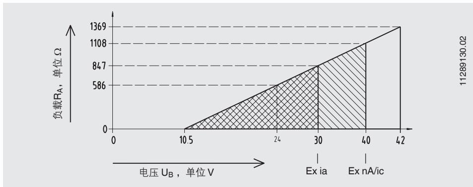
对于电源，请使用限能电路（EN/UL/IEC 61010-1，第 8.3 节），并使用以下电源最大值：
