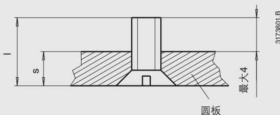
在将变送器固定到测量内芯之前，检查螺钉长度：将螺钉插入圆板，并验证长度为4毫米！
